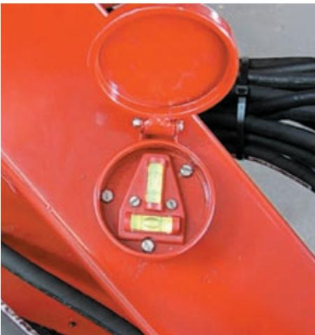
Bild 3-5: Kreuzlibelle – Wasserwaage
