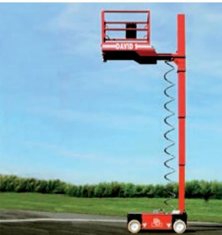
Bild 3-2: Stempelmastbühne Typ 3a
