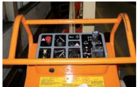
Bild 6-3: Schutzbügel gegen unbeabsichtigtes Betätigen der Bedienelemente
