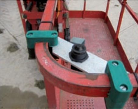
Bild 6-5: Absicherung von Bedienpult und Geländer durch Sensortechnik
