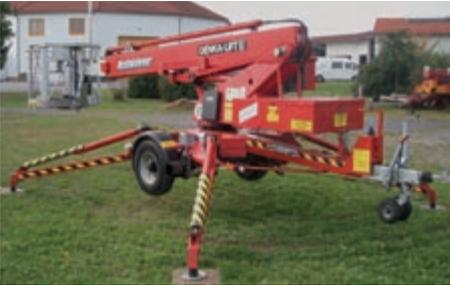
Bild 3-1: Teleskopmastbühne Typ 1b
