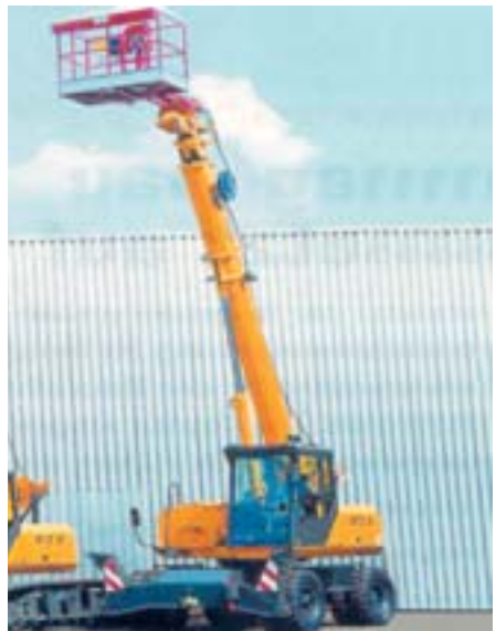
Bild 2-9: Kran mit Arbeitskorb
